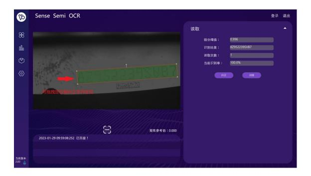
如要纠正字符的识别结果,双击取像区(即图片位置),会生成一个可编辑文本框,在该文本框里手动输入正确的字符结果。
