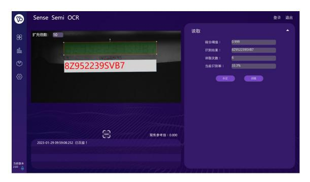
点击"纠正"按钮,将纠偏和纠正后的图像和识别结果编辑框中的内容作为样本数据添加到服务器的"训练数据路径"中,如果左上方的"扩充倍数"框的值为10,则程序会将当前样本经过数据增强后复制10份到服务器的"训练数据路径",完成上述操作后,点击"训练"按钮,服务器的数据样本库会基于提供的样本数据重新训练。
