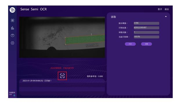
右侧则会显示当前产品字符读取的得分阈值(即置信度),识别的字符结果则会显示在右侧的读取列表区和图片中的编辑区。
